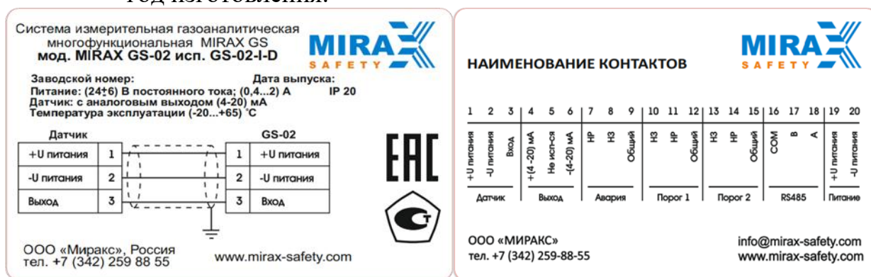
Рисунок 2 – Боковые наклейки контроллера
